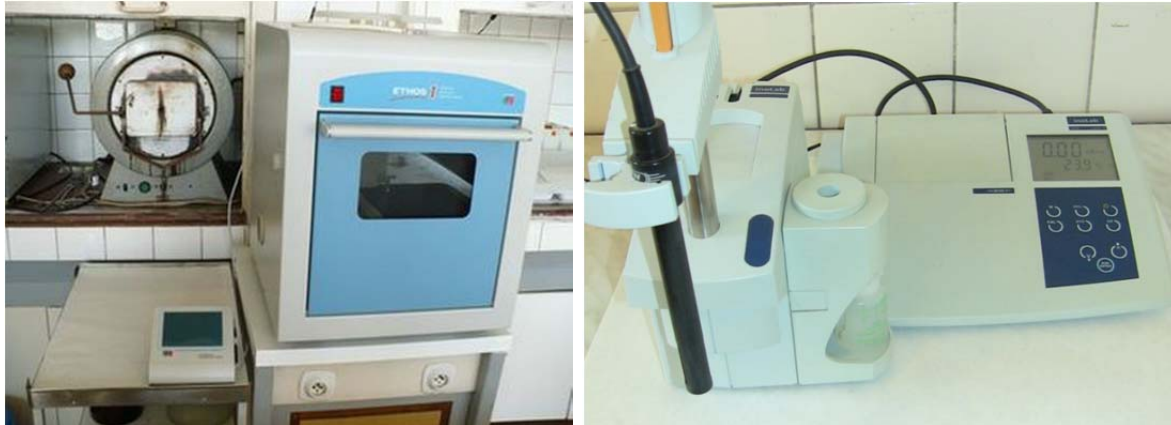
Obr. 3 Zařízení pro rozklad (mineralizaci) biologických vzorků a konduktometr InoLab Cond Level 2
