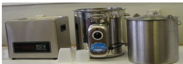
Pasterizační lázeň MILKY a termostat – výroba kysaných mléčných výrobků a čerstvých sýrů
