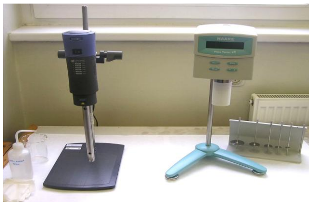
Homogenizátor a viskozimetr HAAKE - posuzování jakosti kysaných mléčných výrobků
